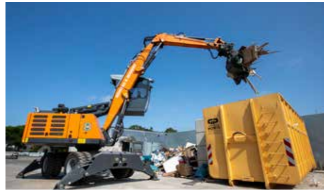
Umschlagsbagger auf dem Betriebshof
