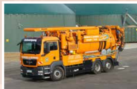
Hochdruckspülwagen mit Wasseraufbereitung
